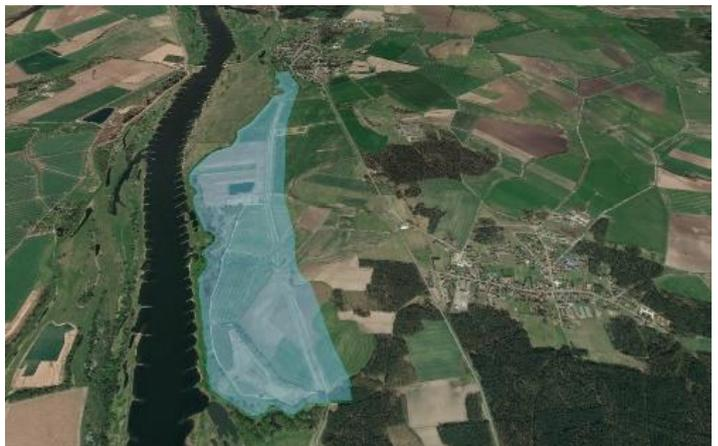
Abbildung des mit dem Luftbild verschnittenen Maßnahmenschnitts der Deichrückverlegung Sandau Süd (Quelle: Ministerium für Wissenschaft, Energie, Klimaschutz und Umwelt Sachsen-Anhalt)
